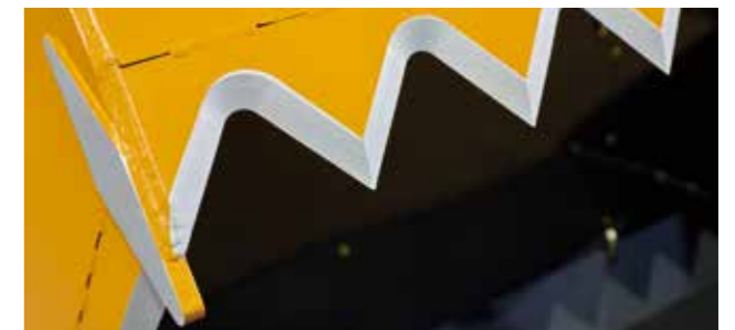
Die geschweißte Hardox-Schneide sorgt für geringen Schneidwiderstand
