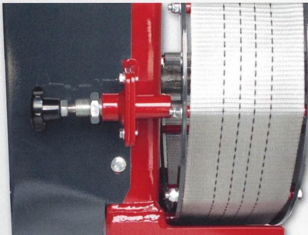
■ Stufenlose Einstellung der Seileinzugsgeschwindigkeit
